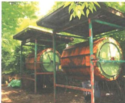
Das Recyceln von organischen Abfällen mit den Rotttrommeln verkürzt die Kompostierung. Weitere Bausteine des Müllverwertungskonzepts sind zum Beispiel die Trennung von Altölen, Metallen, Holz und Papier.
