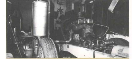
**1981** Energie aus dem Mao-Diesel! Ein ausgedienter LKW-Motor liefert als Prototyp Strom und Wärme für die tapferen Ökopioniere. Wunderwerk der Technik, von vielen bestaunt!
